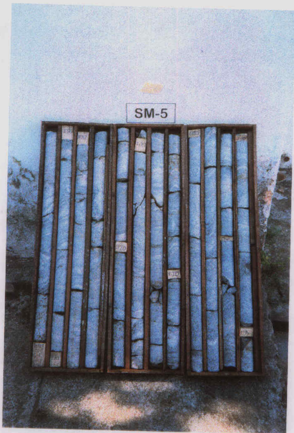
SM-05 / Est. 28 = Início da rocha 8.70 - Final 20.70m, (Recuperação entre 87 a 100%)
