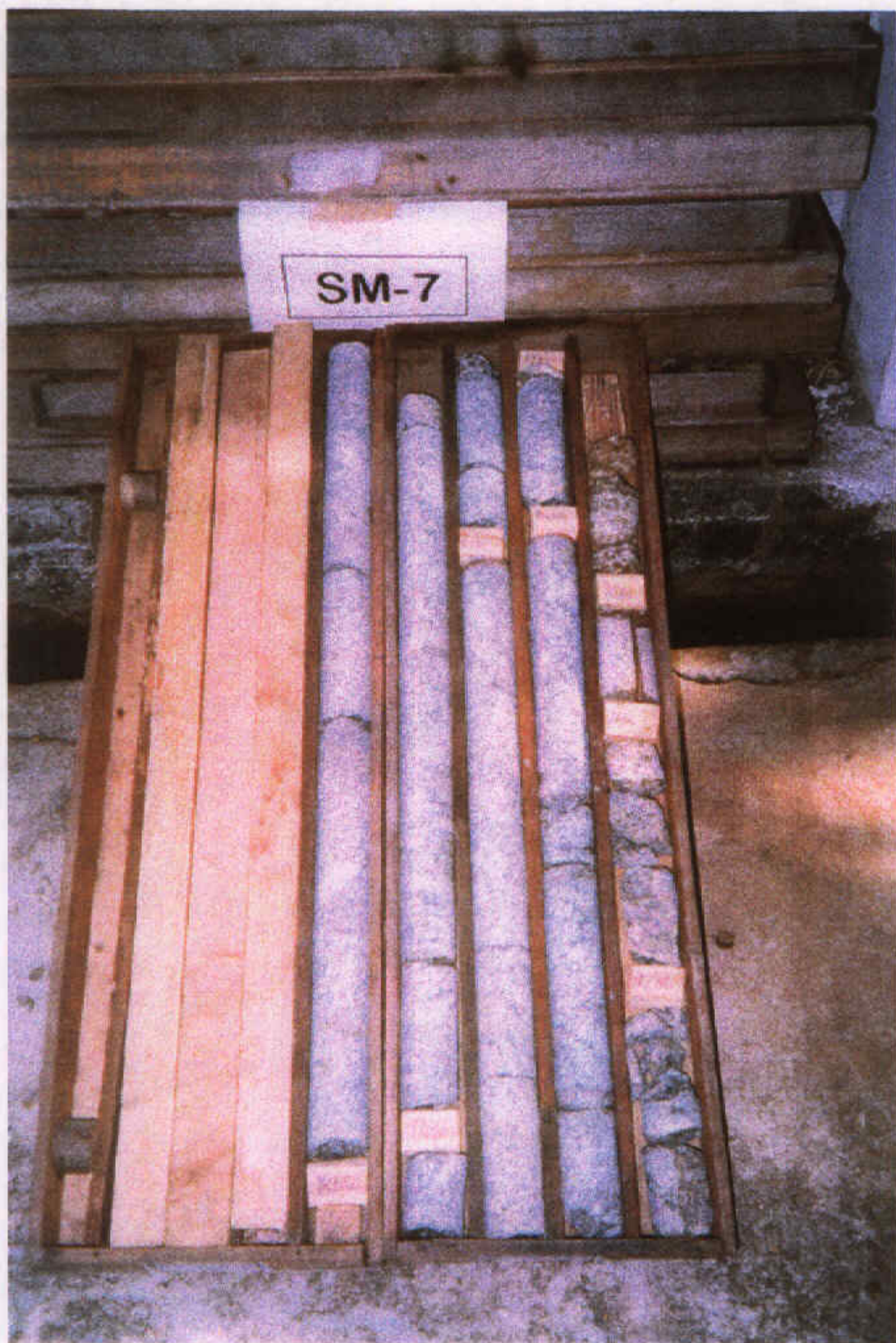
SM-07 / Est. 16 = Início da rocha 9.66 - Final 18.66m, (Recuperação de 14 a 25% entre 9.66 a 14.66m), (Recuperação de 65 a 100% abaixo de 14.66m)
